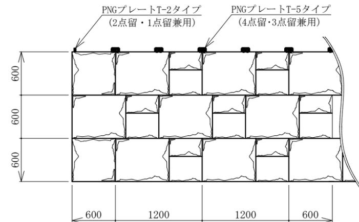
断面図(標準組立図) S=1/25
